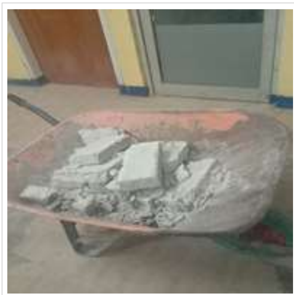
Gambar 5. Bata dengan sekam padi sesudah dites kuat tekan hanya mengalami retak ringan, dan tanpa sekam padi hancur
